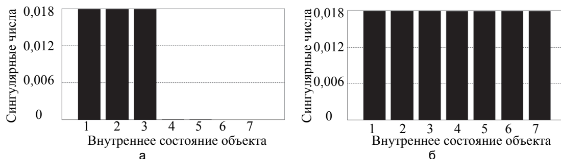
Рис. 2. Сингулярные числа объекта управления: при двухдвигательном управлении (а); при однодвигательном управлении (б)
