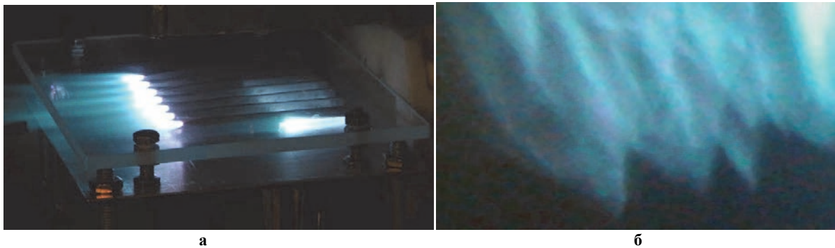
Рис. 2. Устойчивое горение пропана в сверхзвуковом потоке (а). Фронт горения (б) совпадает с линиями распространения возмущений в сверхзвуковом потоке с M=2 . Расстояние между электромагнитными вибраторами на фрагменте (а) и конусами горения (б) 50 мм
