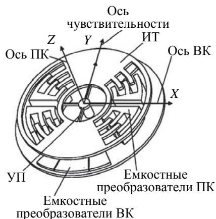
Рис. 1. Схема микромеханического гироскопа RR-типа
