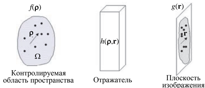
Рис. 1. Линейная система отображения контролируемой области пространства с точечными объектами в двумерное изображение
