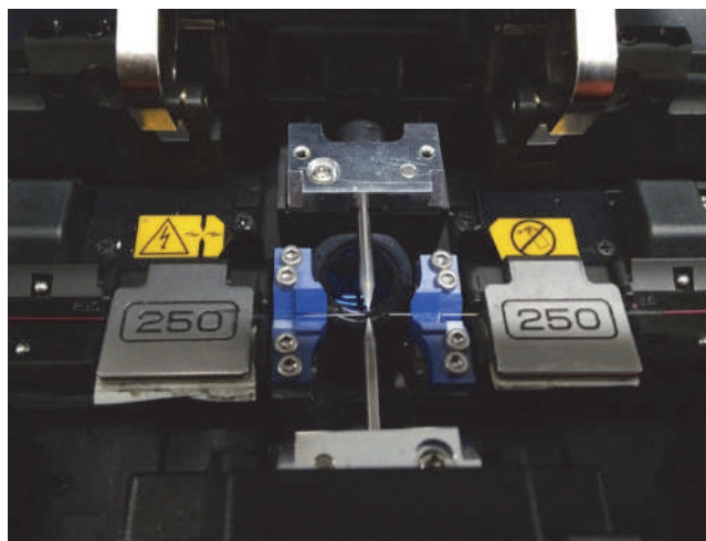
Рис. 2. Укладка оптического волокна в сварочный аппарат Fujikura FSM-100M/P
