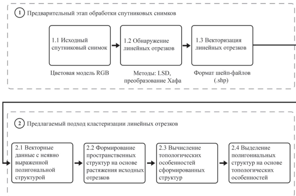
Рис. 2. Общая схема предлагаемого метода кластеризации объектов линейного типа с учетом предварительной обработки спутниковых снимков
