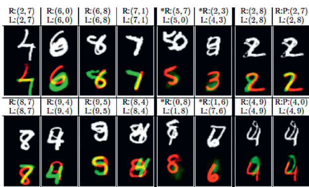
Рис. 5. Примеры раздельного распознавания сетью наложенных цифр: L — истинные цифры; R — цифры, реконструированные сетью; P и «*» — ошибки, обусловленные неправильной классификацией или реконструкцией, или предъявлением сети неизвестных ей символов
