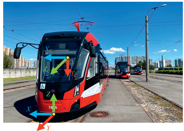
Рис. 5. Схематическое изображение и системы координат двухсекционного трамвая: упрощенная схема двухсекционного трамвая для реализации кинематической модели (a); система координат объекта и система координат камеры (b)
