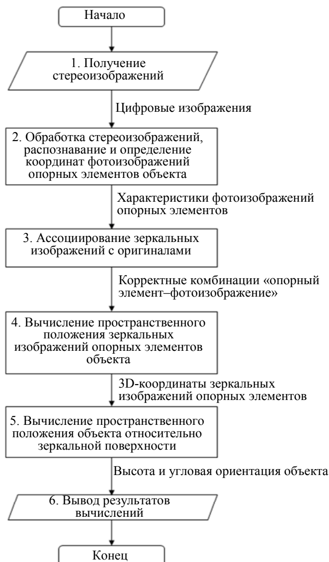
Рис. 4. Обобщенная блок-схема алгоритма вычисления пространственного положения объекта
