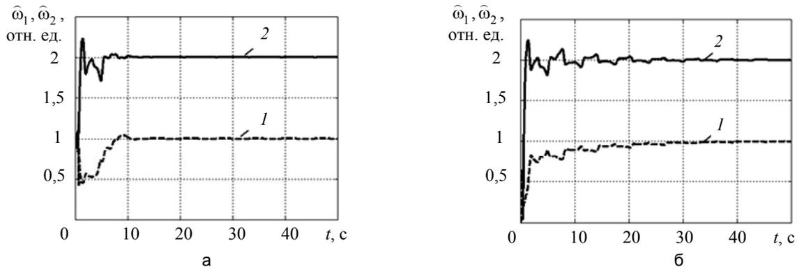
Рисунок. Результаты моделирования алгоритмов оценивания частот сигнала  $y(t)$  ( $\hat{\omega}_1$  – кривая 1;  $\hat{\omega}_2$  – кривая 2): оценка частот алгоритмом (8)–(9) (а); оценка частот алгоритмом [4] (б)
