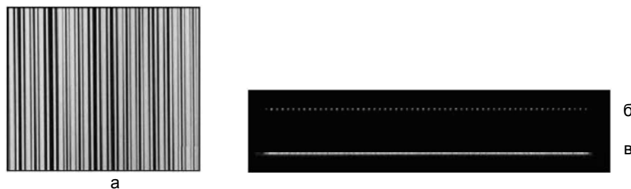
Рис. 2. Схема гомогенизатора (а) и линий лазерного излучения, сформированных интегратором Келера (б) и одномерными нерегулярными диффузорами (в) [1]
