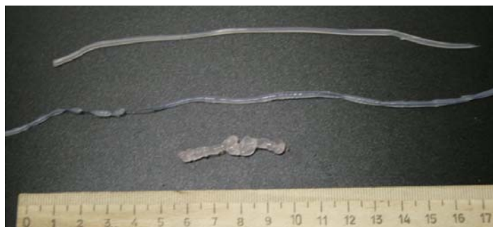
Рис. 4. Капилляроподобные фантомы из силикона
