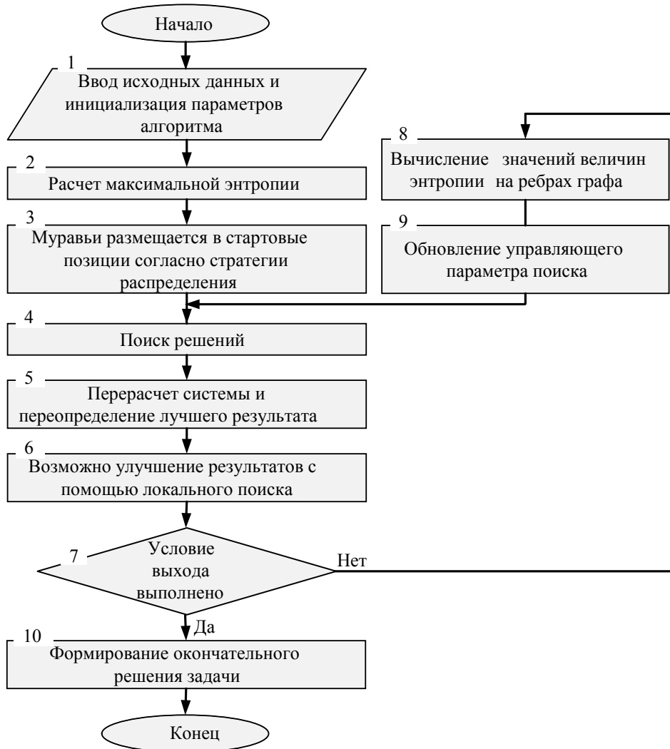
Рисунок. Упрощенная схема модифицированного муравьиного алгоритма
