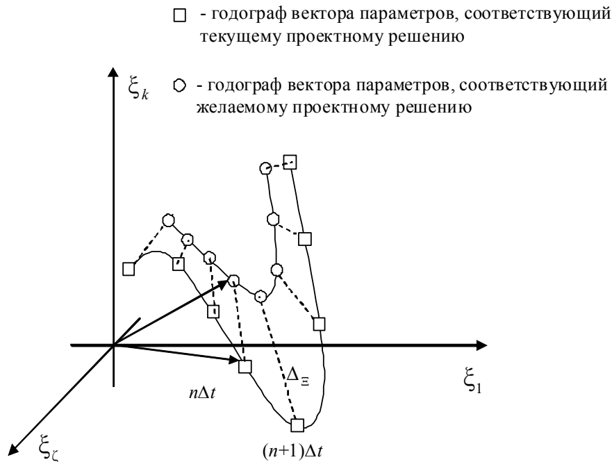
Рис. 2. Геометрическое представление длины вектора и оценка близости текущего проектного решения желаемому (заданному по ТТЗ) в векторном пространстве
