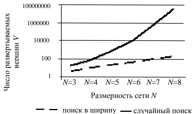
Рис. 2. Сравнение поиска в ширину и случайного поиска
