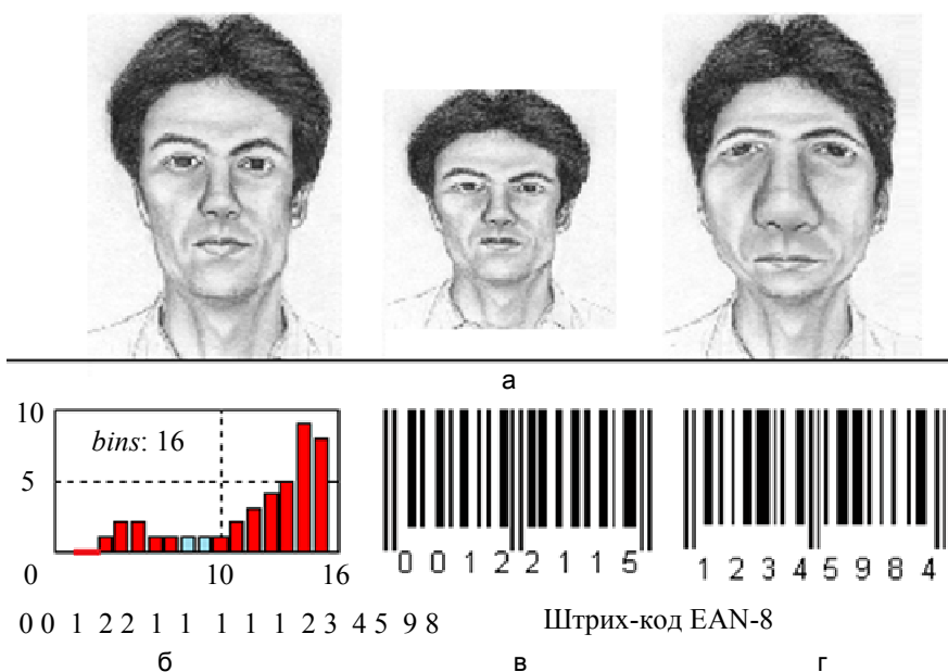
Рис. 6. Результаты формирования штрих-кода для базы: оригинальный скетч и его модификации (а); гистограмма яркости (одинаковая для всех скетчей), рассчитанная для bins=16 (б); штрих-коды для первых семи и последних семи значений гистограммы соответственно (в, г)
