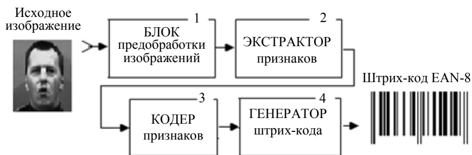
Рис. 1. Структура системы формирования штрих-кода
