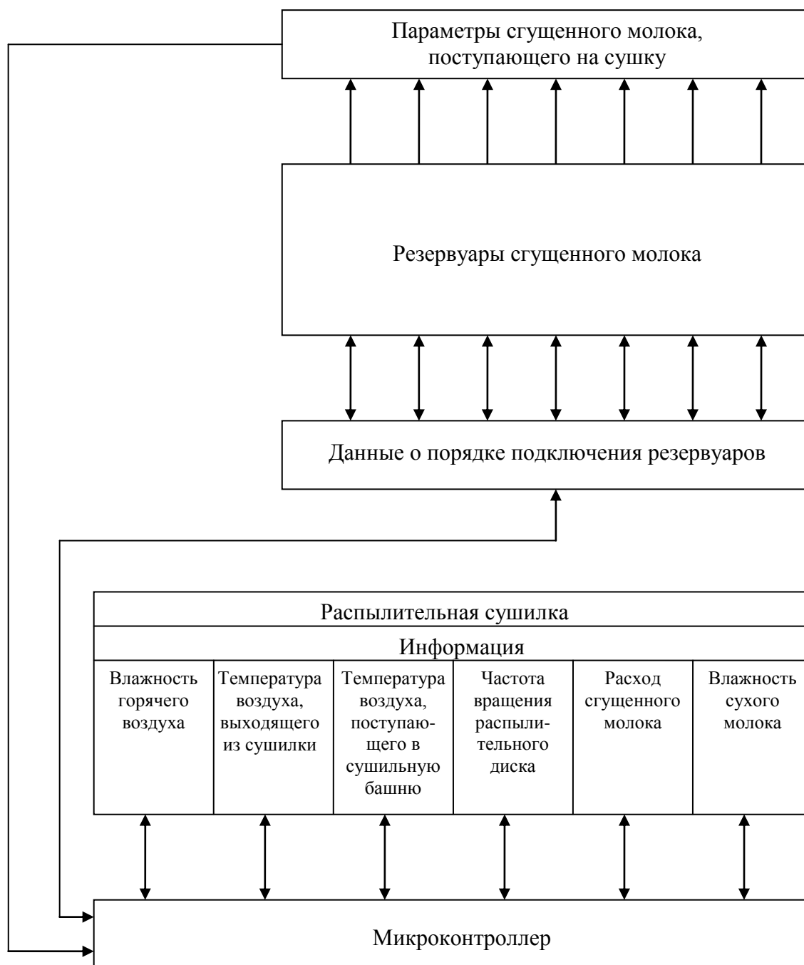
Рис. 5. Структурная схема стабилизации сухих молочных продуктов по влажности
