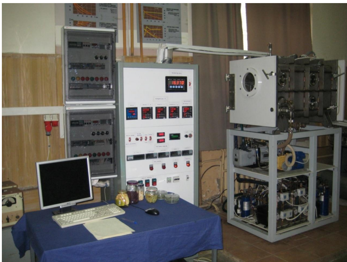
Рис. 1. Общий вид лабораторного комплекса СВП-0,36 для изучения процессов вакуумного обезвоживания
