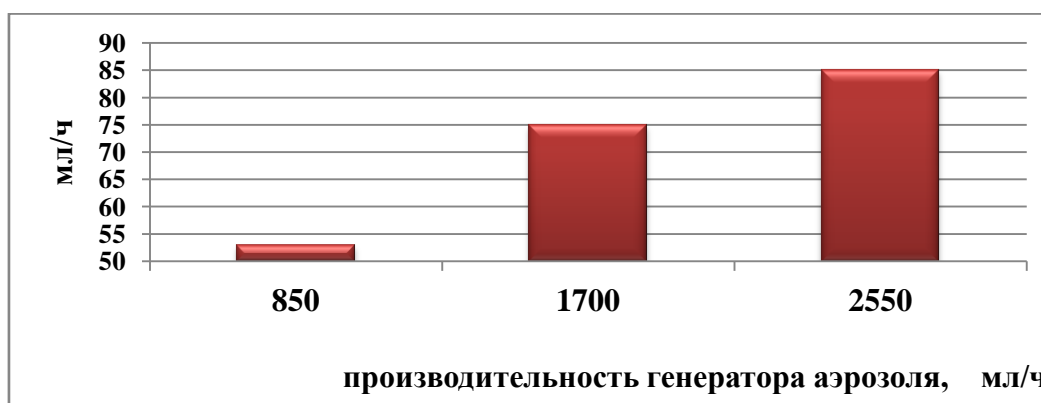
Рис. 3. Производительность установки по копильной жидкости в случае отсутствия направленного распространения ультразвуковых колебаний
