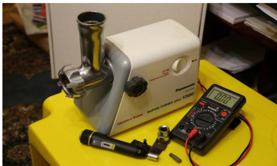
Рис.1. Установка для определения влияния момента затяжки на энергетические и тепловые параметры процесса измельчения в волчках
