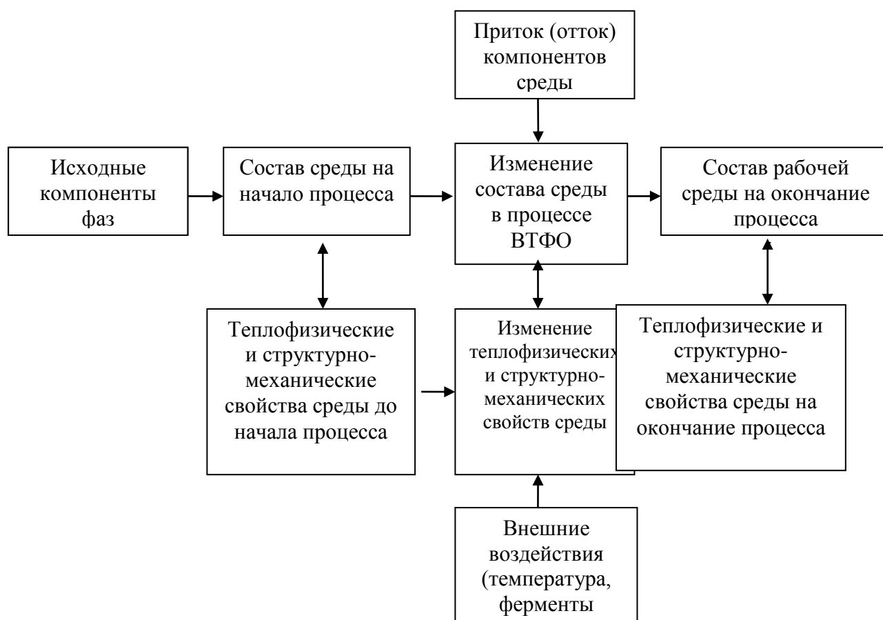
Рис. 2. Формирование подсистемного «Среда» на конкретной стадии технологического процесса
