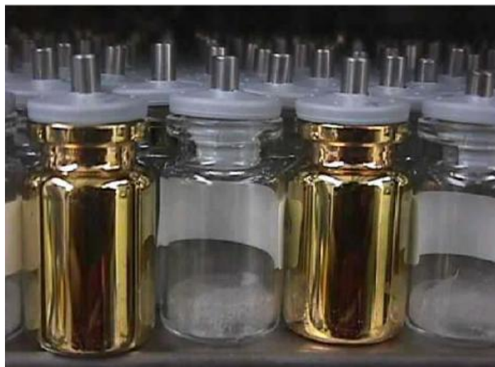
Рис. 19. Размещение флаконов с золотым покрытием и чистых флаконов на полке сушильной установки. Стальные трубки вставлены в пробки
