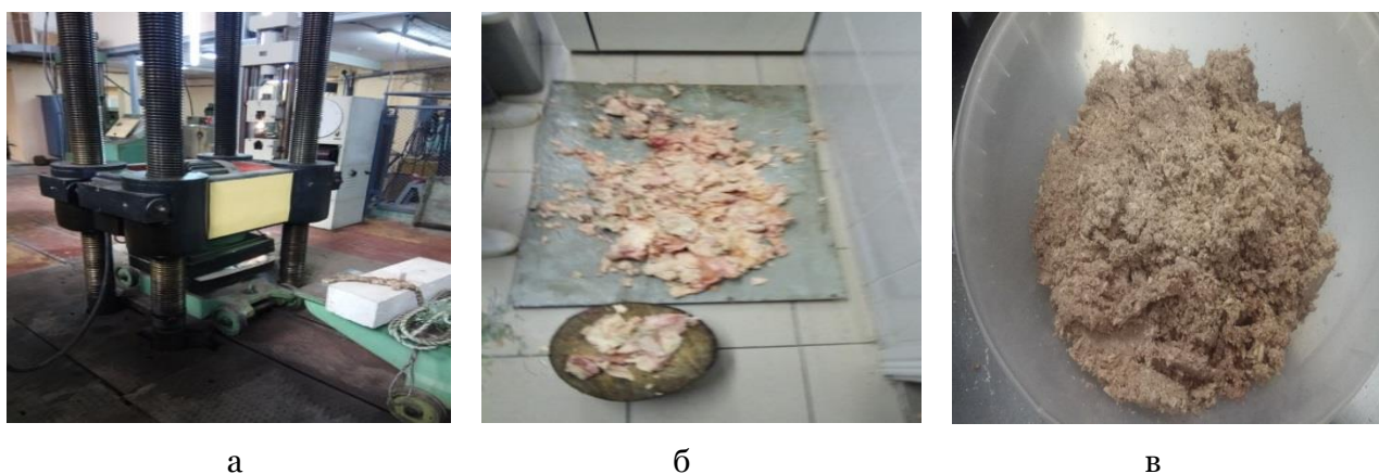
Рисунок 1 – Первичное измельчение говяжьих мослов с помощью строительного пресса: а – установка для первичного измельчения; б – грубо измельченные костные ткани; в – измельченные костные ткани Figure 1. Primary crushing of beef mosles by building press: а – unit for primary crushing; б – coarse crushed bones; в – crushed bones
