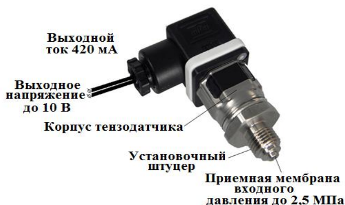
Рисунок 4 – Фотография датчика давления P401
