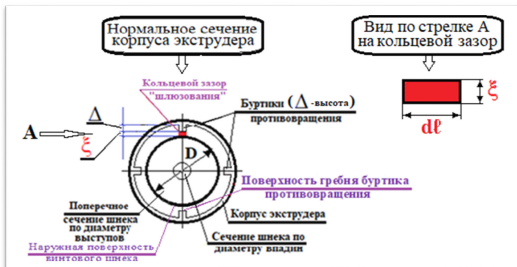
Рисунок 1 – Схема и параметры кольцевого зазора в поперечном сечении экструдера Figure 2. Diagram and parameters for circular sluice gap at the extruder cross-section
