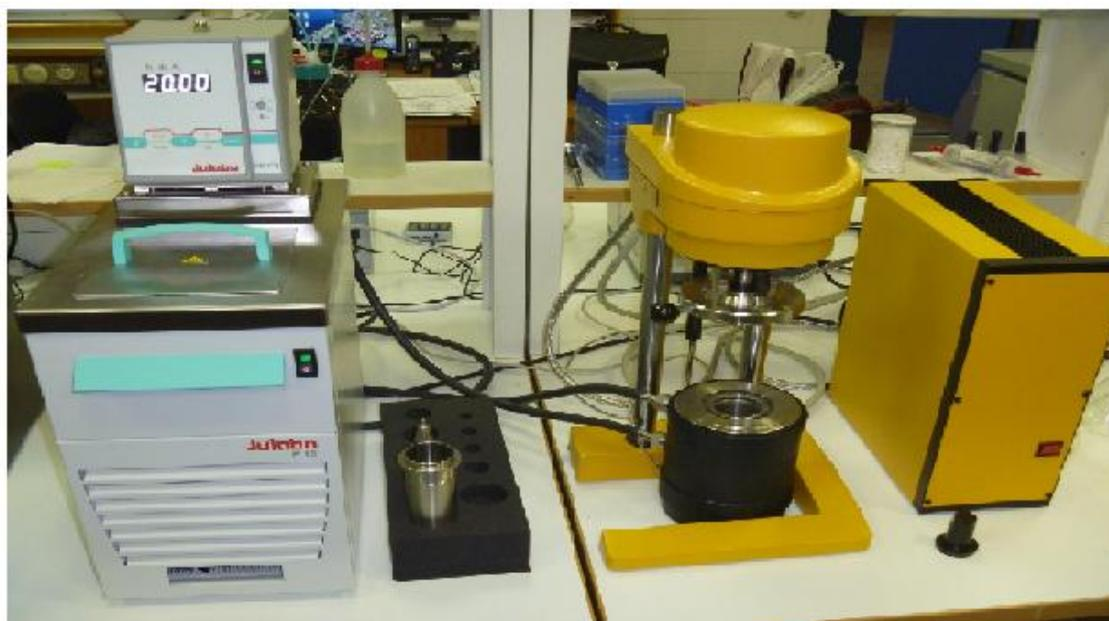
Рис. 1. Ротационный вискозиметр Rheotest-Medingen GmbH HRn4.1
