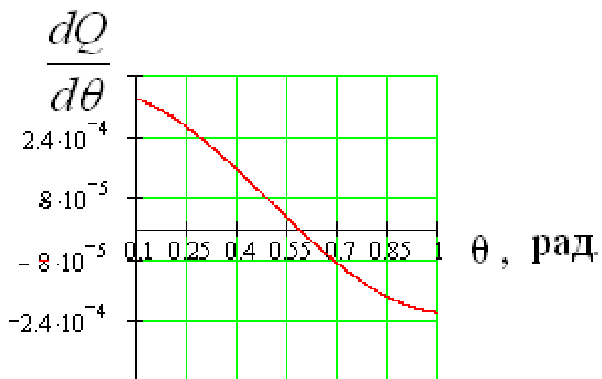
Рис.2. Зависимость объемного расхода от угла подъема винтовой линии червяка
